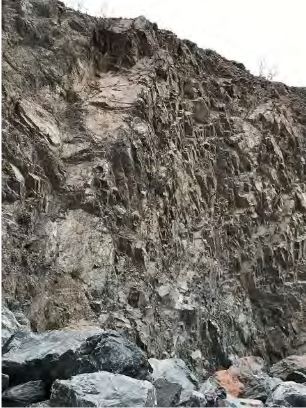
Observation depuis BSL 17 front nord à proximité SBL08 = métavolcanite et schistes fracturés
