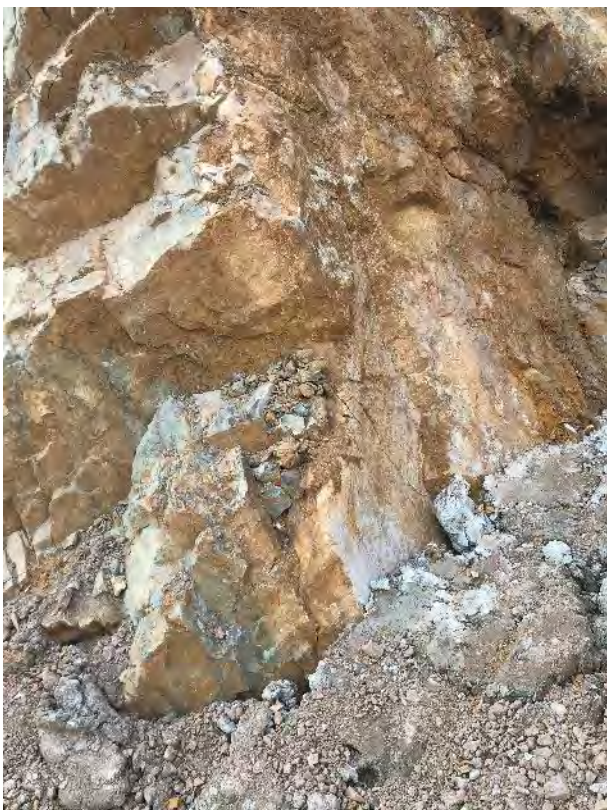
Observation BSL11 = plan de faille normal à jeu décrochant dans massif altéré à chlorite. Pyrite et chalcopryrite disséminées.
