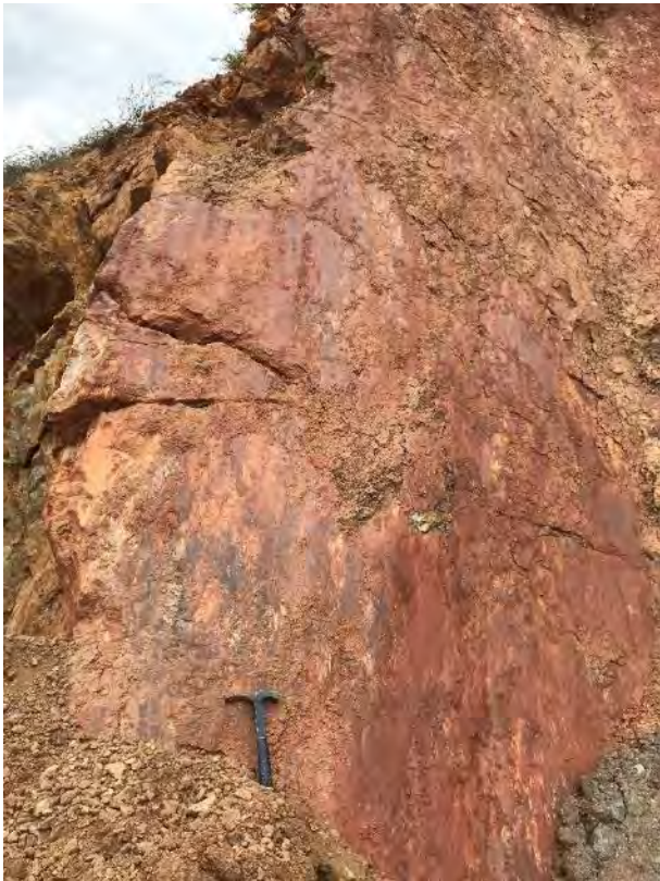
Observation BSL08 = Plan de faille majeure entre schistes et zone altérée à blocs.
